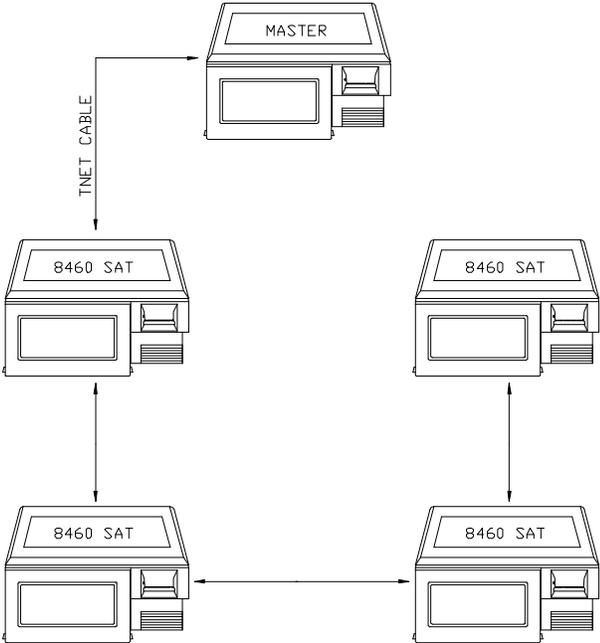
Figure 2-1 Example M/S Network (TNET)
