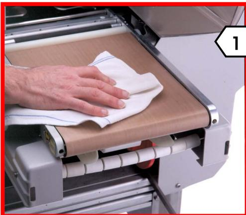
Nettoyer la courroie chauffante avec un chiffon doux imbibé d'eau chaude. Attention ! La courroie peut être très chaude ! Laisser refroidir avant de procéder au nettoyage.
