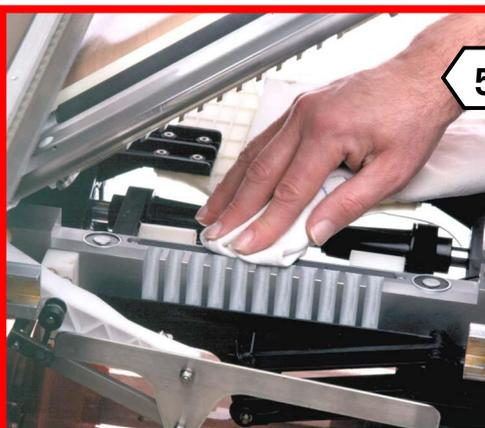
Alors que le convoyeur est en position levée, nettoyer la bande de caoutchouc du distributeur avec un chiffon humide. Pour abaisser le convoyeur, le tenir par la poignée et le descendre délicatement.
