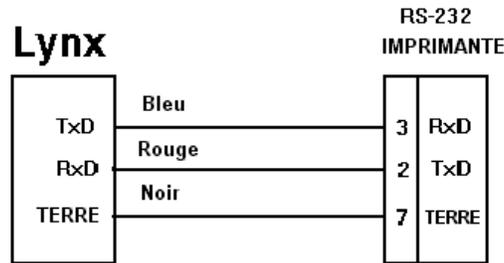
Figure A1-1 : Branchement du Câble de l'Imprimante RS-232
