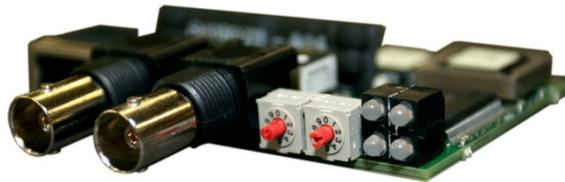
**Figure 3-1: ControlNet PLC Module**
