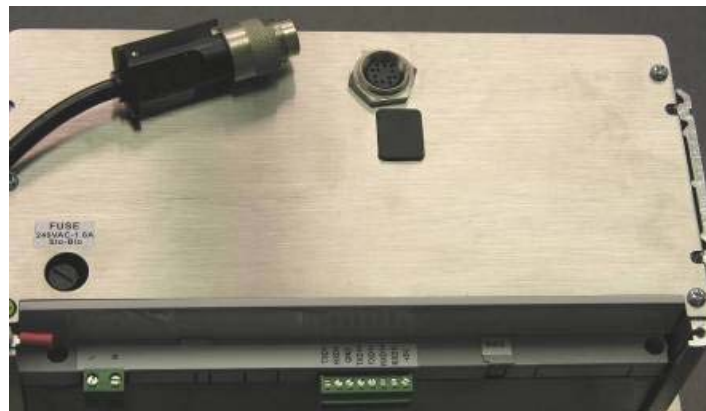
Abb. 2-17: Position des IDNet-Steckanschlusses auf dem Gehäuse für den Schalttafleinbau
