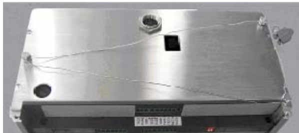
Figura 2-37: Sellado externo para Canadá
