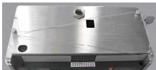
Figure 2-37 : Apposition externe de sceau pour le Canada
