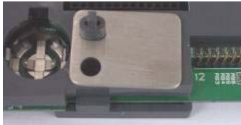
Abb. 2-40: Versiegelungsplatte aus Metall
