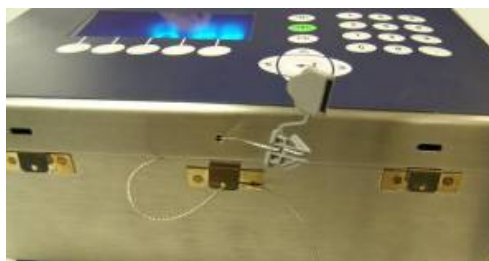
Figure 2-38 : Apposition externe de sceau sur la version environnement hostile
