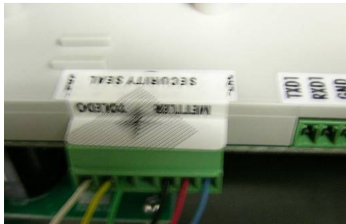
Abb. 2-42: Papiersiegel der Analog-Wägezelle
