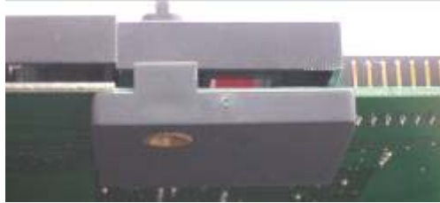
Abb. 2-39: Befestigung der unteren Versiegelungsplatte aus Kunststoff
