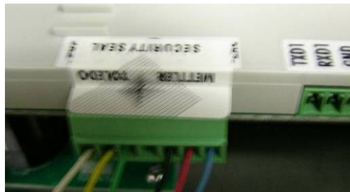
Figura 2-42: Sigillo di carta della cella di carico analogica
