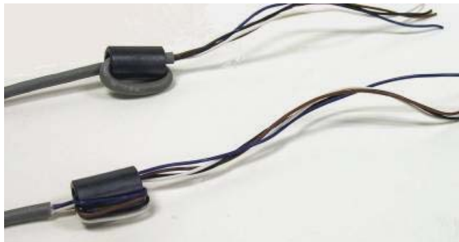
Abb. 2-11: Einbau der Ferritkerne
