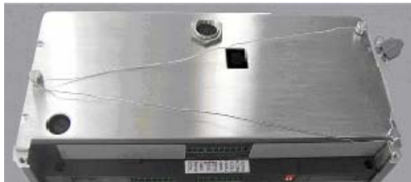
Figura 2-37: Sigillatura esterna per il Canada
