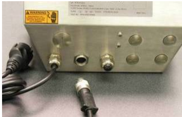
Figura 2-16: Postazione del connettore IDNet sull'armadietto per ambienti difficili
