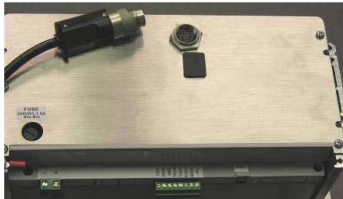
Figura 2-17: Ubicación del conector IDNet en la caja para montaje en panel
