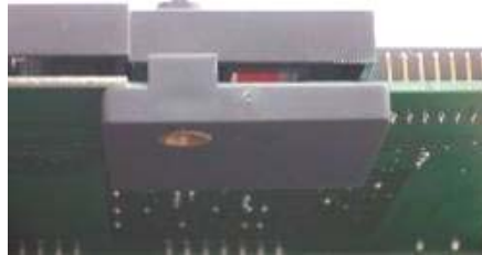
Figure 2-39 : Fixation de la plaque d'apposition de sceau inférieure en plastique
