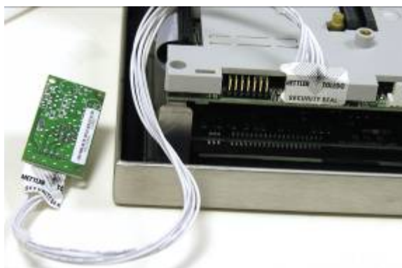
Figure 2-43 : Sceaux en papier de l'IDNet
