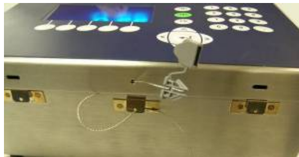
Abb. 2-38: Externe Versiegelung des Gehäuses für raue Umgebungen
