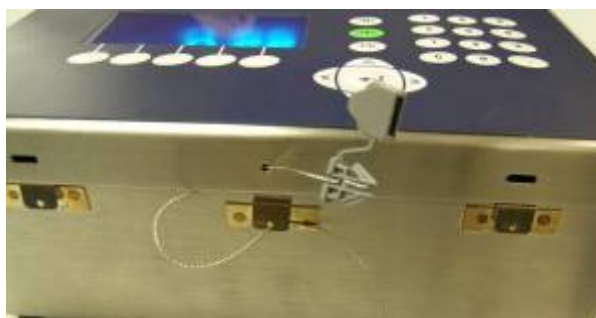
Figura 2-38: Sigillatura esterna per armadietto per ambienti difficili
