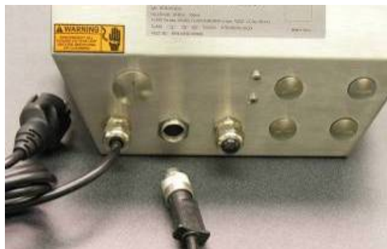
Figure 2-16 : Emplacement du connecteur IDNet sur une enceinte version environnement hostile
