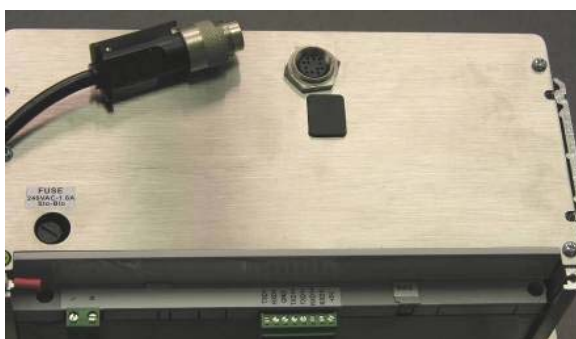
Figure 2-17 : Emplacement du connecteur IDNet sur une enceinte version montage sur tableau
