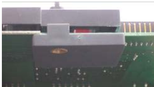
Figura 2-39: Come attaccare la piastra di sigillatura inferiore in plastica
