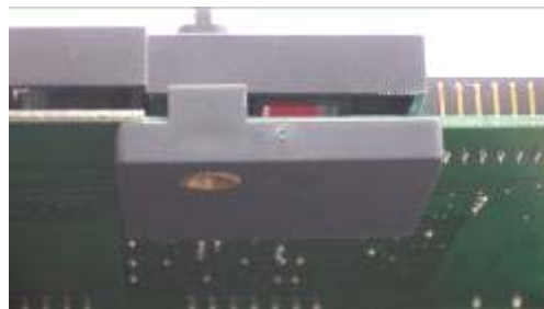
Figura 2-39: Fijación de la placa de sellado inferior de plástico
