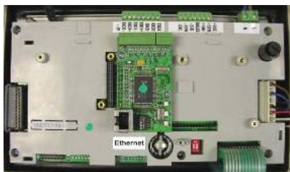
Figura 2-26: Etichetta Ethernet sull'armadietto per ambienti difficili
