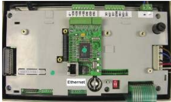
Figura 2-26: Etiqueta de Ethernet en la caja para ambientes adversos
