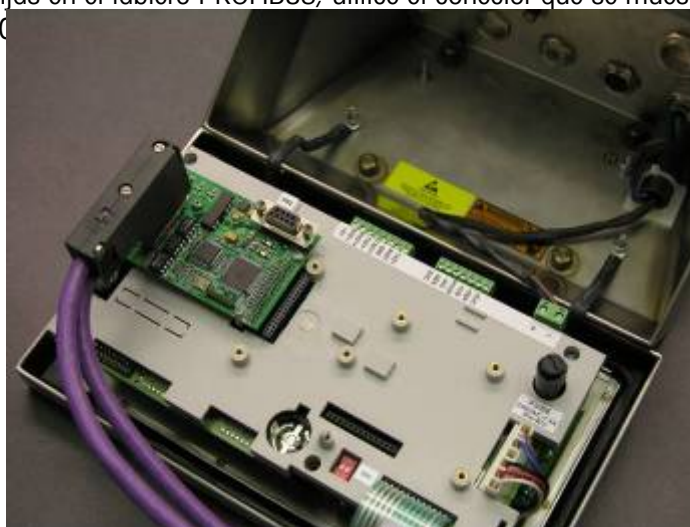
Figura 2-30: Conexión PROFIBUS hacia la caja para ambientes adversos
