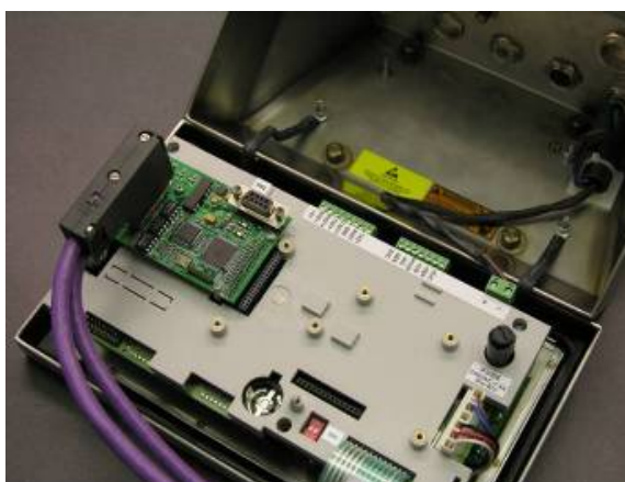
Figura 2-30: Connessione PROFIBUS all'armadietto per ambienti difficili
