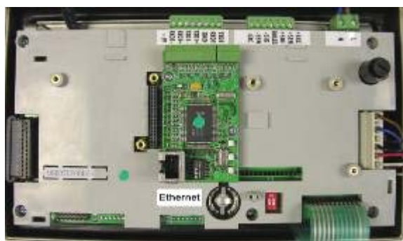
Figure 2-26 : Étiquette Ethernet sur l'unité version environnement hostile
