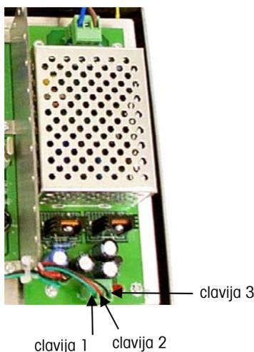
**Figura 4-4:** Las clavijas 1, 2 y 3 en el tablero de la fuente de energía
