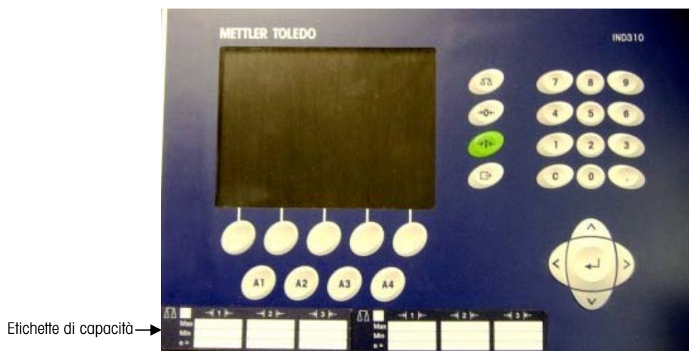
Figura A-13: etichette di capacità per un sistema a due bilance
