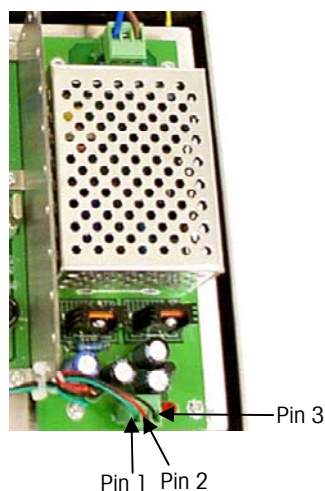
Figura 4-1: Pin 1, 2, e 3 sulla scheda di alimentazione elettrica
