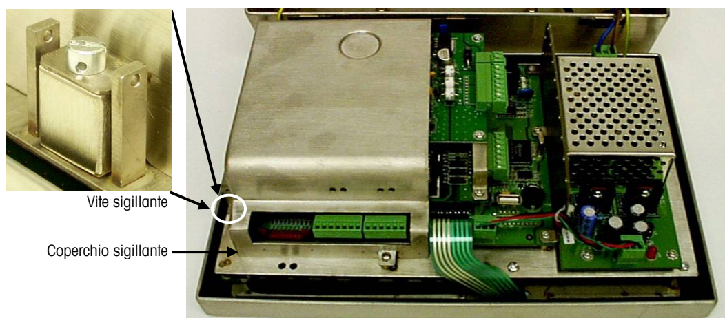
Figura A-15: Sigillatura interna
