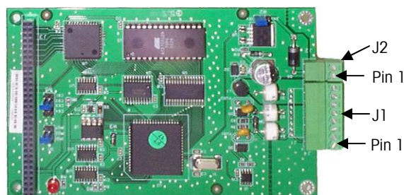
Figura A-9: Ubicazioni dei collegamenti della scheda POWERCELL
