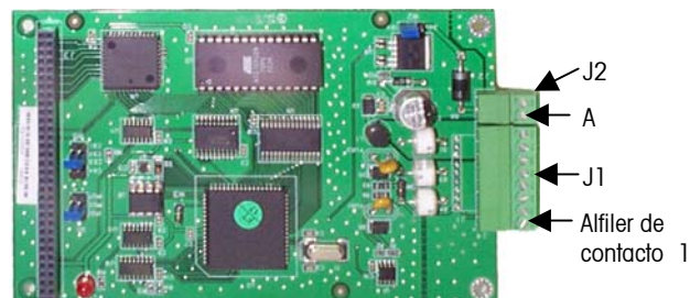
Figura 2-9: Ubicación de los conectores en la tarjeta POWERCELL
