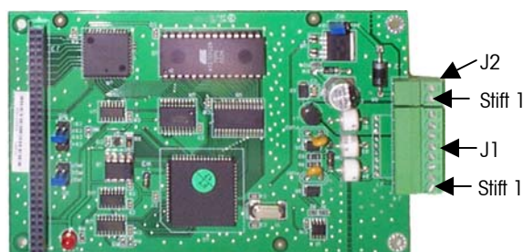
Abbildung 2-9: Positionen der POWERCELL-Platinensteckverbinder
