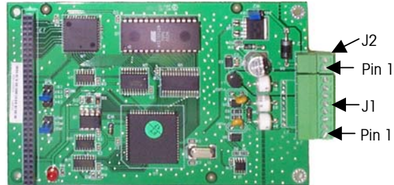
Figura 2-9: Ubicazione dei connettori della scheda POWERCELL
