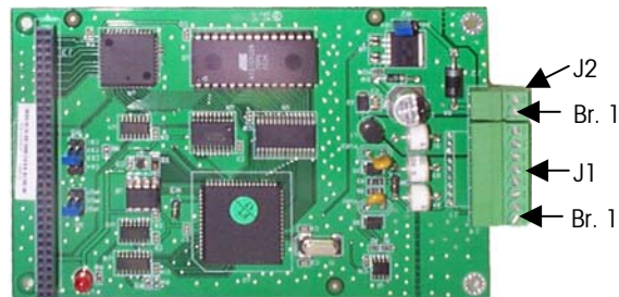
Figure 2-9 : Emplacement des connecteurs sur la carte POWERCELL
