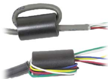
Figura 2-24: Installazione del nucleo in ferrite
