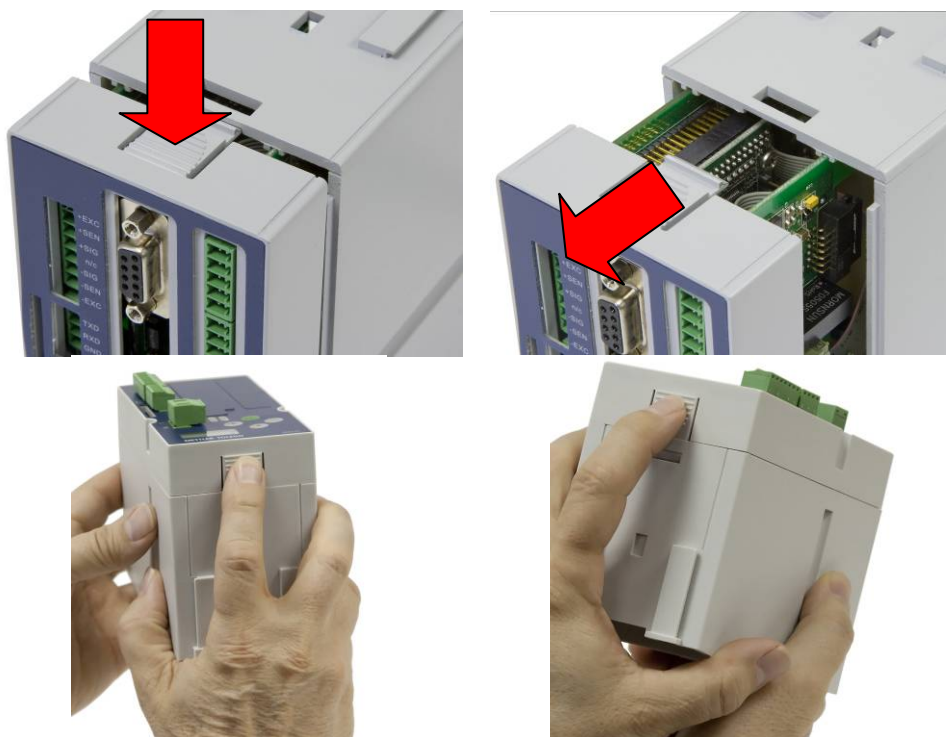
Abbildung 2-1: DIN- und Schalttafelgehäuse öffnen
