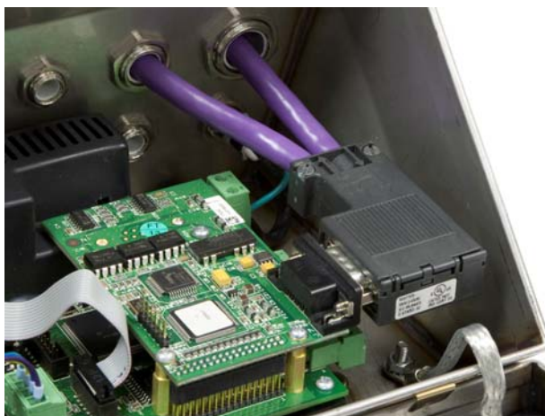
Figura 2-61: Colocación del cable PROFIBUS en el gabinete para ambientes adversos
