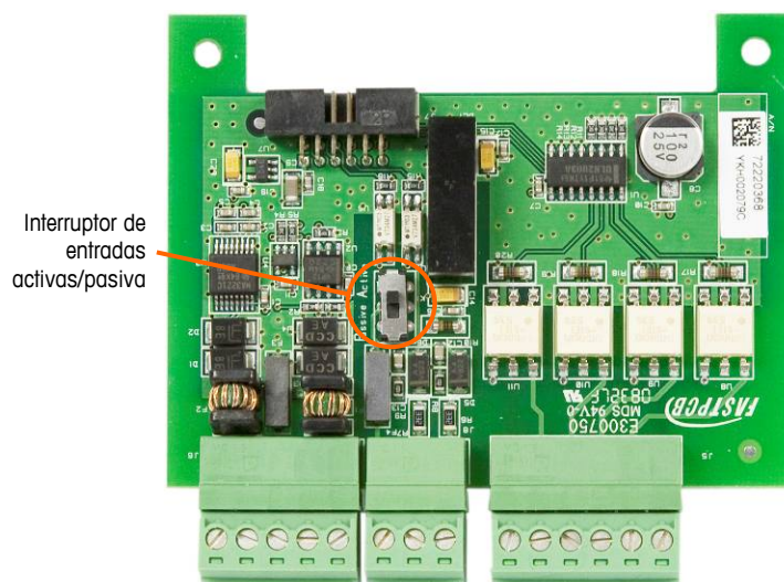
Figura 2-50: Tarjeta opcional COM2/E/S discontinuas (estado sólido)
