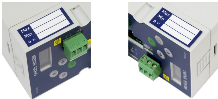
Figure 2-73: Emplacements pour l'étiquette de capacité, unité DIN
