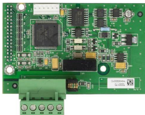
Figura 2-53: Tarjeta opcional de salida analógica
