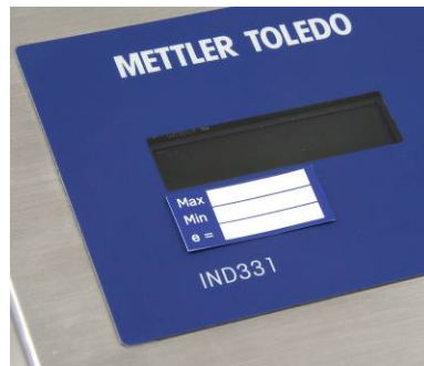
Abbildung 2-74: Position des Kapazitätsaufklebers, Gerät für raue Umgebungen
