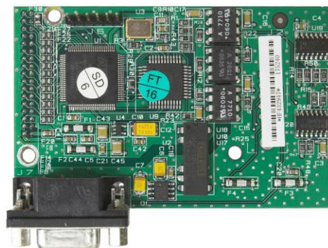
Figura 2-59: scheda opzionale PROFIBUS, armadietto con montaggio a pannello
