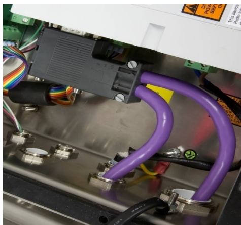
Figure 2-62: Acheminement des câbles PROFIBUS pour boîtier J-Box, version originale
