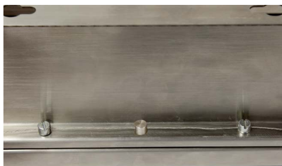
Figura 2-78: sigillo della versione con scatola di giunzione, versione originale, perno e viti di sigillo
