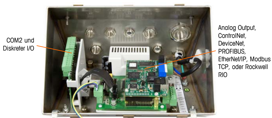
Abbildung 2-43: Optionspositionen im Gehäuse für raue Umgebungen
