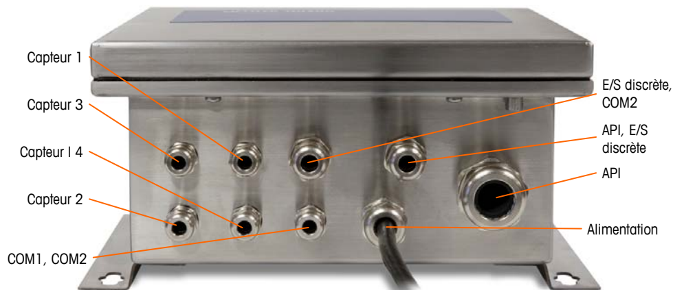
Figure 2-26: Affectations du presse-étoupe d'un boîtier J-Box, version originale
