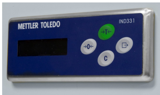
Figure 2-11: Montage de l'interface opérateur
