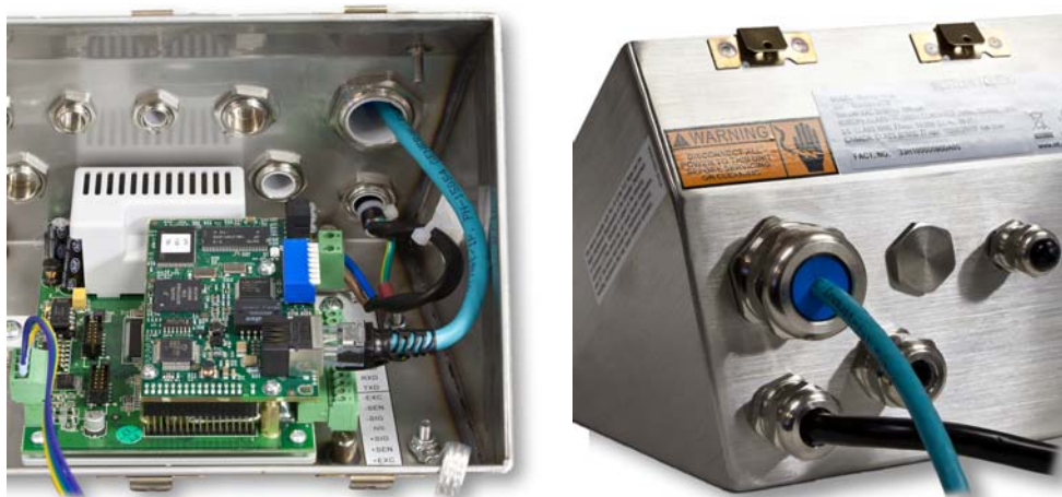
Figure 2-65: Acheminement des câbles Ethernet pour boîtier version environnement rude
