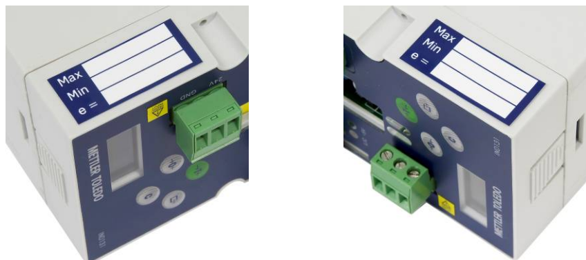
Figura 2-73: Colocación de la etiqueta de capacidad, unidad DIN
