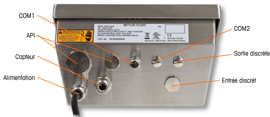
Figure 2-25: Affectations du presse-étoupe d'un boîtier pour environnement rude
