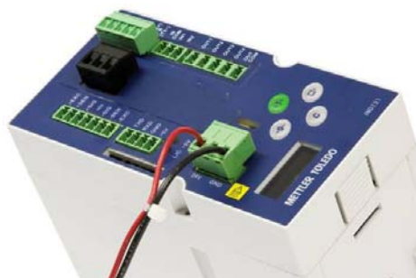
Figura 2-32: Connessione alimentazione CC
