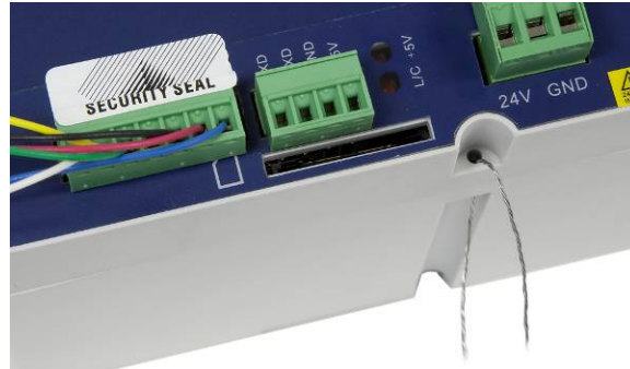
Abbildung 2-76: Versiegeln der DIN- und Schalttafelversion – Draht- und Papiersiegel
