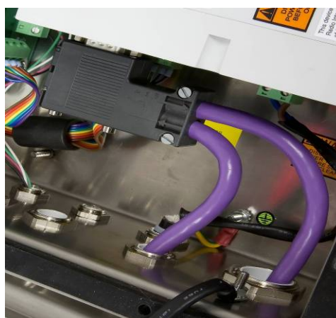
Abbildung 2-62: PROFIBUS-Kabelführung für das Abzweigkastengehäuse, Originalversion
