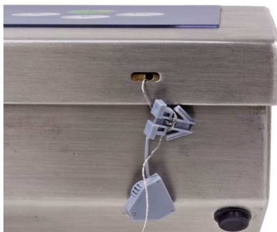
Figure 2-77: Apposition des sceaux pour version environnement rude, acheminement des fils
