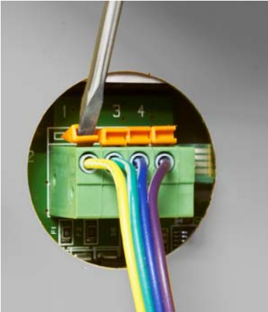
Figura 2-16: Palancas anaranjadas en el conector de la tarjeta de la pantalla
