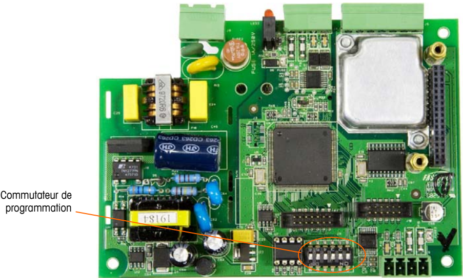
Figure 2-71: Zone de commutateurs DIP de la carte PCB principale
