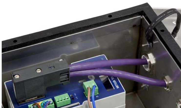
Abbildung 2-63: PROFIBUS-Kabelführung für das Abzweigkastengehäuse, Aktualisierten version
