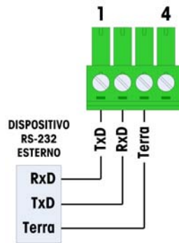
Figura 2-41: Connessioni RS232 campione
