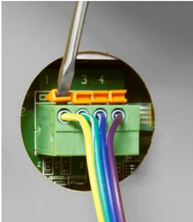
Figure 2-16: Leviers orange sur le connecteur de la carte de l'afficheur
