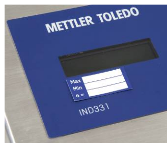
Figura 2-74: Colocación de la etiqueta de capacidad, unidad para ambientes adversos
