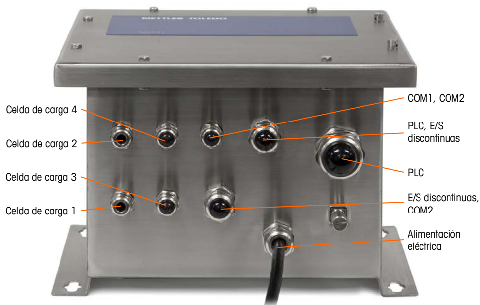
Figura 2-27: Asignaciones de casquillos en el gabinete para caja de conexiones, versión actualizada
