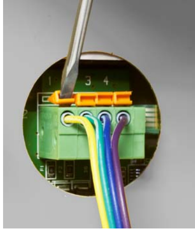
Abbildung 2-16: Orangefarbene Hebel auf dem Display-Platinenanschluss
