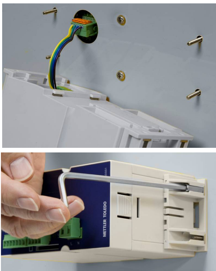
Figura 2-14: installazione del modulo DIN
