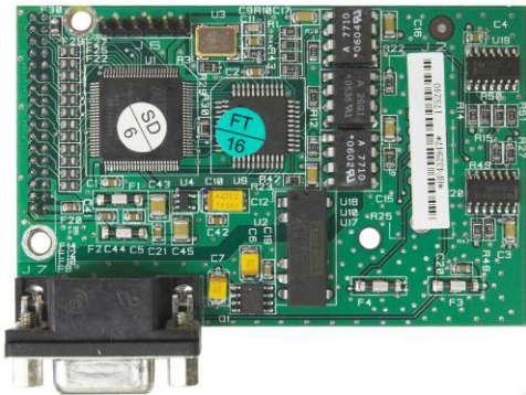
Figura 2-59: Tarjeta opcional PROFIBUS, gabinete para montaje en panel
