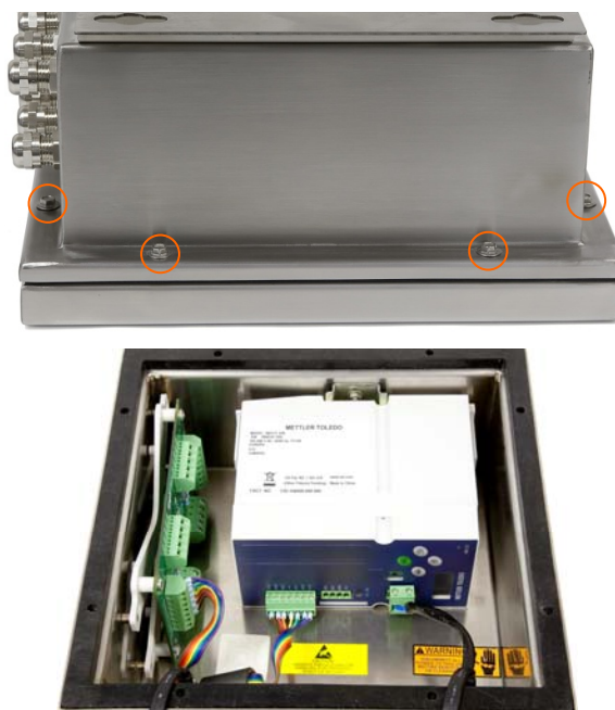
Figura 2-2: viti dell'armadietto della scatola di giunzione, versione originale
