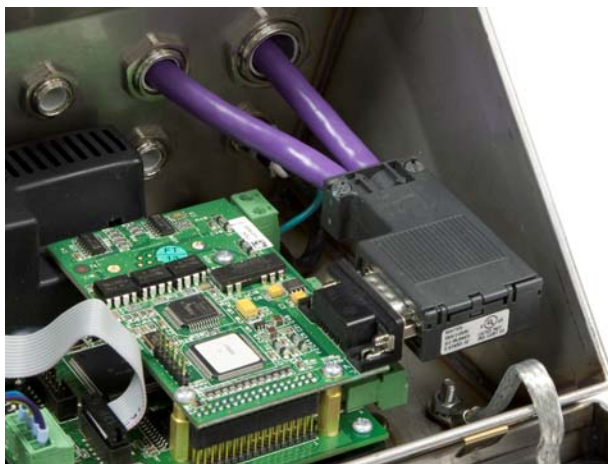
Figure 2-61: Acheminement des câbles PROFIBUS pour boîtier version environnement rude
