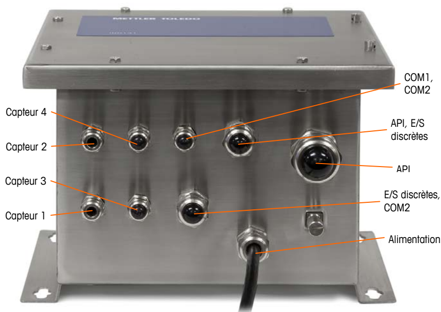
Figure 2-27: Affectations du presse-étoupe d'un boîtier J-Box, version mise à jour
