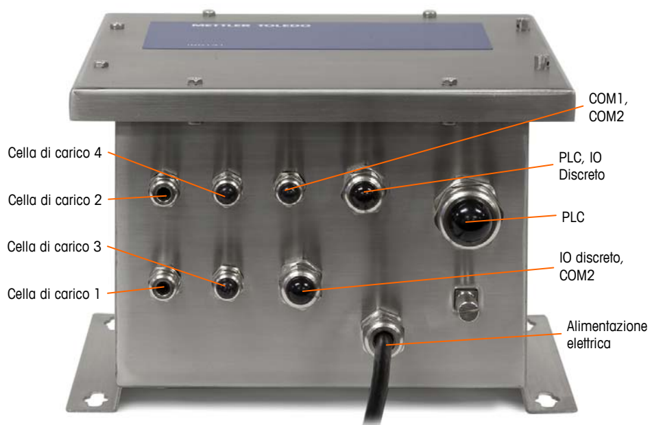
Figura 2-27: Assegnazioni dei pressacavi della scatola di giunzione, versione aggiornato
