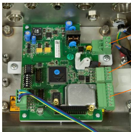
Abbildung 2-31: Anschlüsse für das Gehäuse für raue Umgebungen
