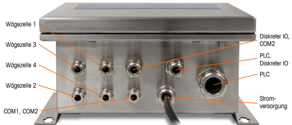
Abbildung 2-26: Kabelstutzenzuweisungen des Original Abzweigkastengehäuses
