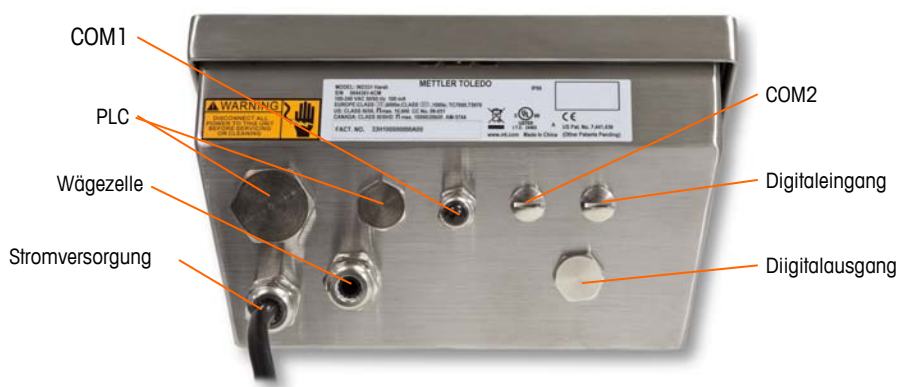
Abbildung 2-25: Kabelstutzenzuweisungen des Gehäuses für raue Umgebungen
