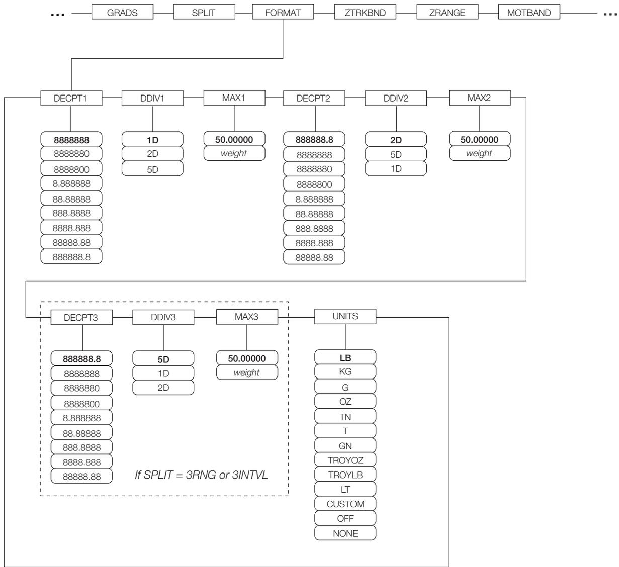
Figure 3-6. SCALES Menu, FORMAT Submenu, SPLIT ≠ OFF
