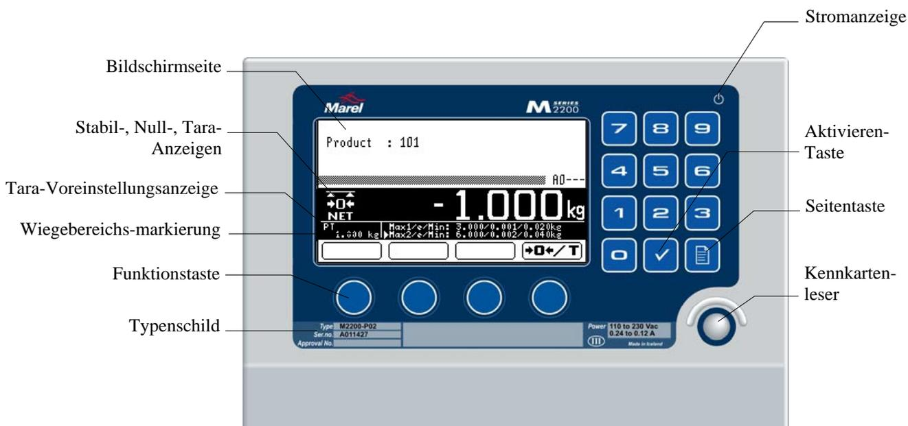
Abbildung 1: Vorderansicht der M2200-Anzeige.
