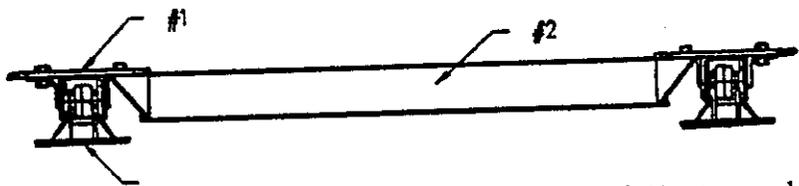
LOAD BAR MOUNTING / Montage des barres de pesage
