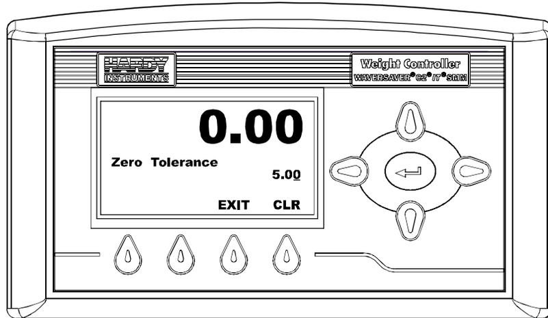
**FIG. 78 ZERO TOLERANCE MENU**
