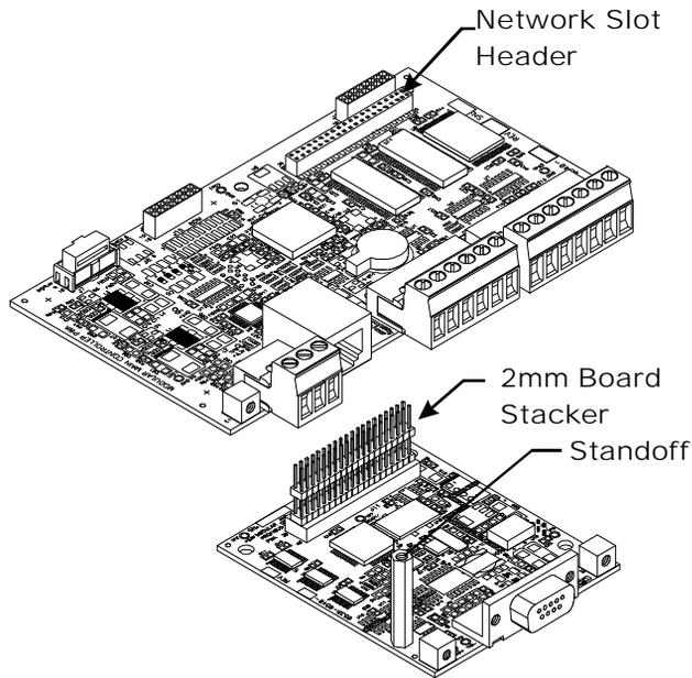
**FIG. 31 INSTALLING PROFIBUS CARD**
