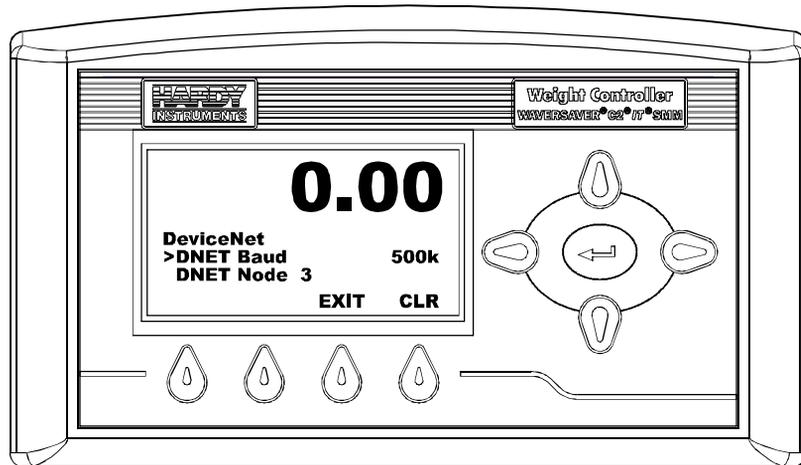
**FIG. 118 DEVICENET MENU/SELECTING BAUD**
