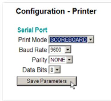
**FIG. 210 CONFIGURATION - PRINTER/SAVING SCOREBOARD PARAMETER**
