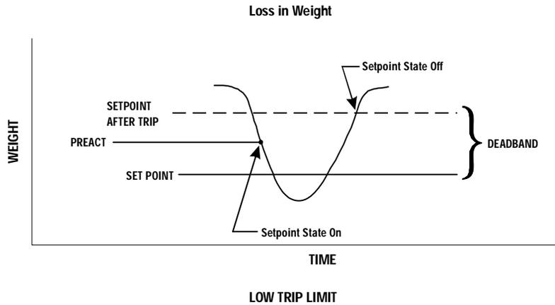
FIG. 51 LOSS IN WEIGHT/LOW TRIP LIMIT
