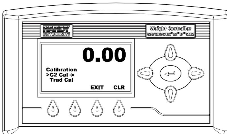
**FIG. 305 CALIBRATION MENU/SELECTING C2 CAL**
