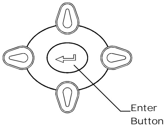
**FIG. 356 LEFT AND RIGHT ARROWS/ENTER BUTTON**
