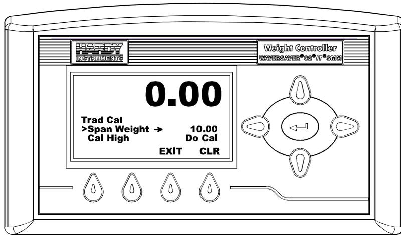
**FIG. 314 TRAD CAL MENU/SELECTING SPAN WEIGHT**
