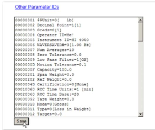
**FIG. 301 PARAMETER DUMP/SAVING PARAMETER CHANGES**
