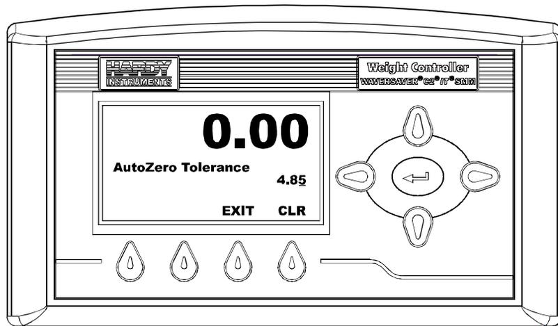
**FIG. 81 AUTOZERO TOLERANCE MENU**
