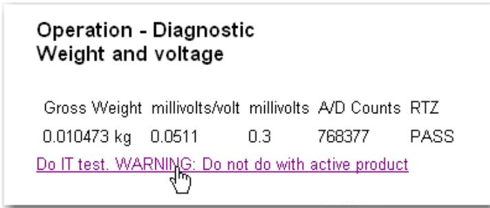
**FIG. 420 WEIGHT AND VOLTAGE/PASSED/SELECTING IT TEST**
