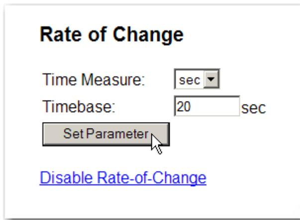
**FIG. 256 RATE OF CHANGE/ENTERING THE TIMEBASE VALUE**
