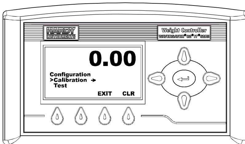
**FIG. 304 CONFIGURATION MENU/SELECTING CALIBRATION**
