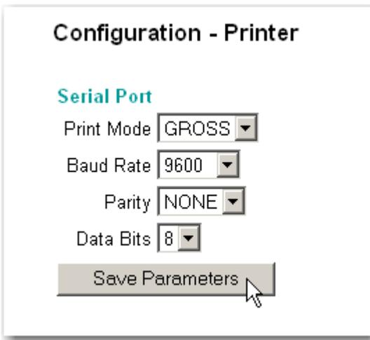
**FIG. 207 PRINTER SETUP SAVING PARAMETERS**
