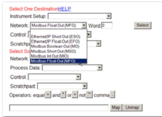
**FIG. 236 DESTINATION NETWORK/MODBUS FLOAT OUT/WORD 0**
