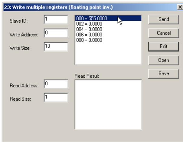
**FIG. 245 HARDY MODBUS-LINK DISPLAY/WRITER MULTIPLE REGISTERS DISPLAY**
