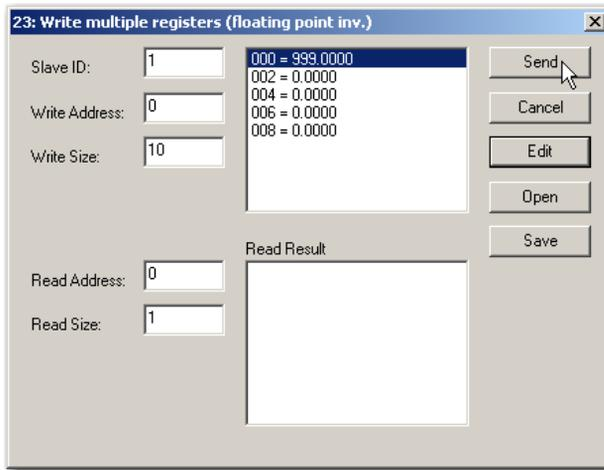
**FIG. 248 HARDY MODBUS-LINK/WRITE MULTIPLE REGISTERS/SENDING NEW VALUE**
