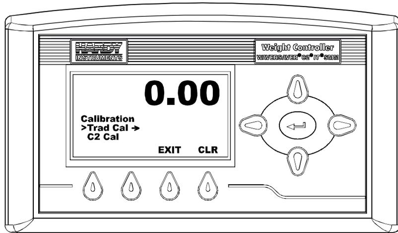
**FIG. 310 CALIBRATION MENU/SELECTING TRAD CAL**
