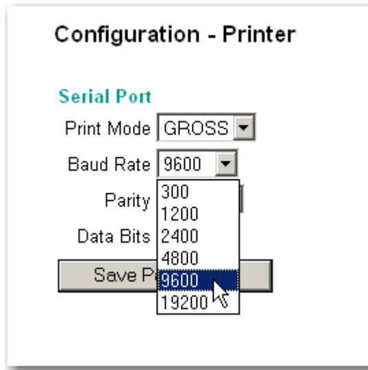
**FIG. 204 PRINTER SETUP/SELECTING BAUD RATE**
