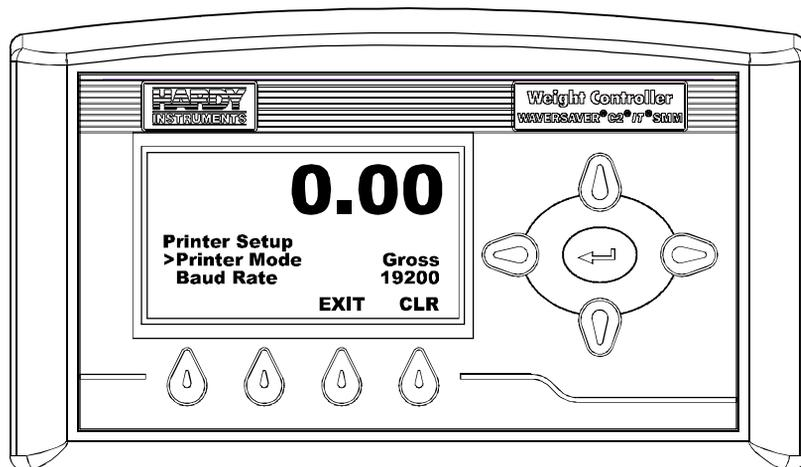
**FIG. 91 PRINTER SETUP MENU/SELECTING PRINTER MODE**
