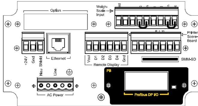
**FIG. 33 PROFIBUS LABEL INSTALLED**
