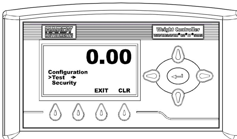
FIG. 387 CONFIGURATION MENU/SELECTING TEST
