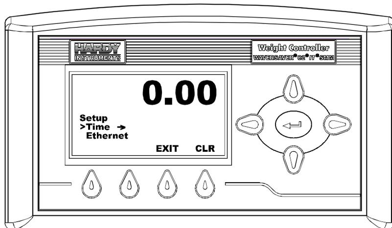
**FIG. 96 SETUP MENU/SELECTING TIME**
