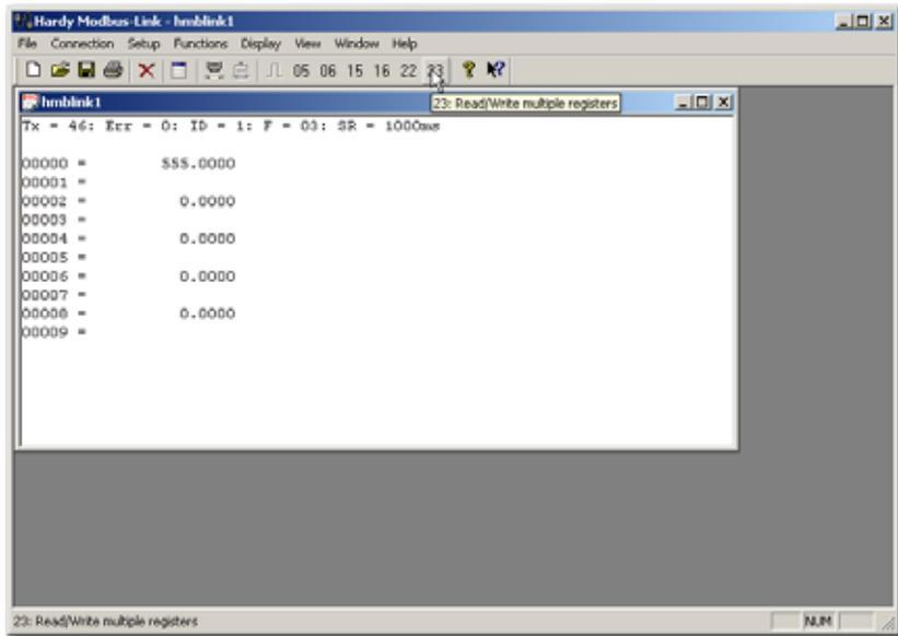
**FIG. 244 HARDY MODBUS-LINK DISPLAY/SELECTING BUTTON 23 - READ/WRITE MULTIPLE REGISTERS**
