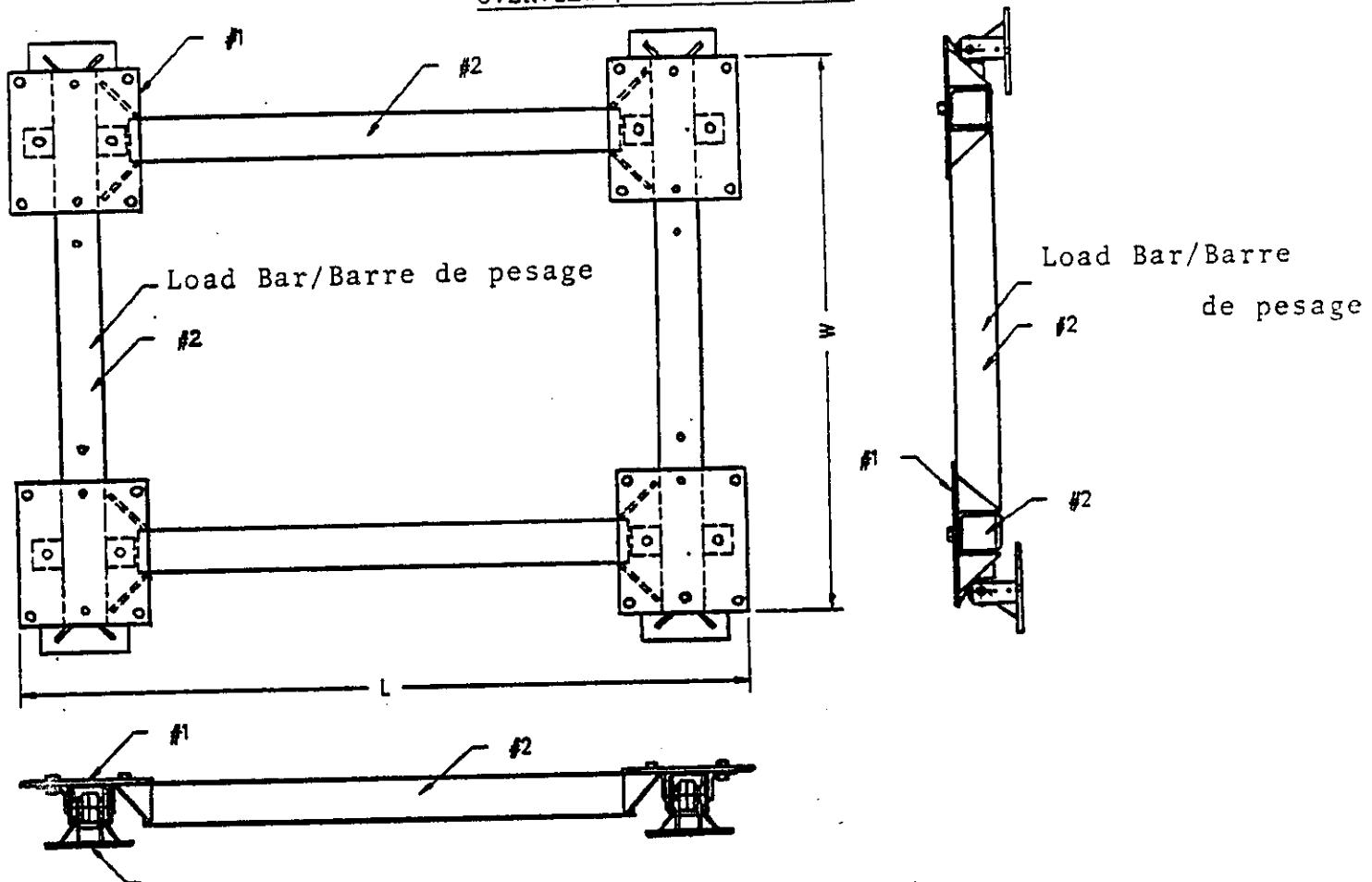
LOAD BAR MOUNTING / Montage des barres de pesage
