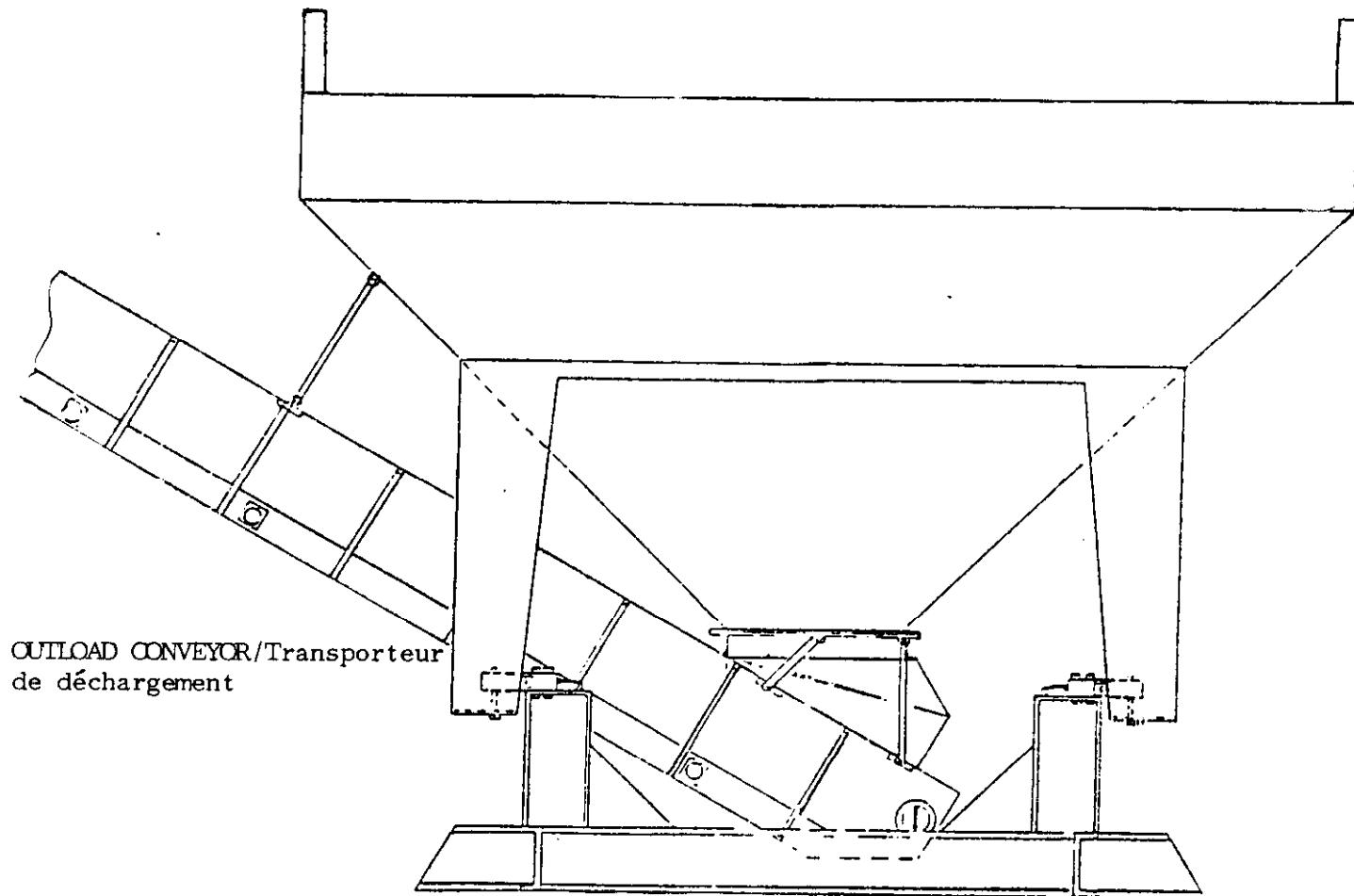
HOPPER SCALE/Bascule à trémie
