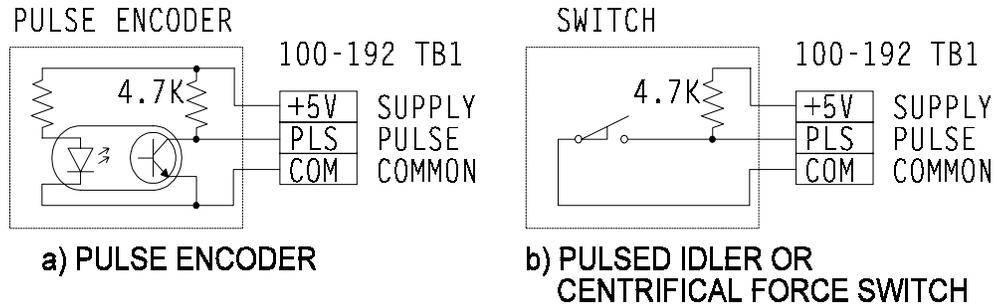
FIGURE 2-3. MOTION DETECTION CIRCUITS
